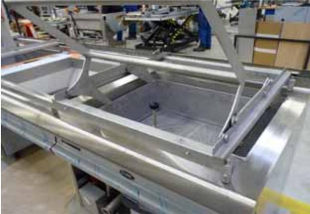
Positionner le panier au-dessus de la cuve de la friteuse.
