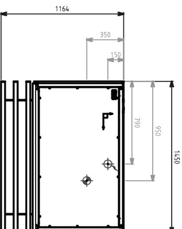
**ELEC :** Puissance Frigorifique : 1910 W - 1 + 1/6 CV    Reservation Elec : Bornier interne    Raccordement Elec : 230V Mono
