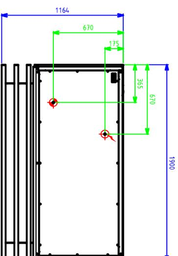
**ELEC :** Puissance Frigorifique : 1706 W - Réservation Elec : Bornier Interne Raccordement Elec : 230V Mono
