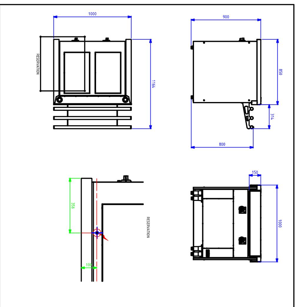
**ELEC :** ⚡ Puissance Electrique dessus: 1.8 kW Réreservation Elec: Boitier interne Raccordement Elec: 400V Tri
