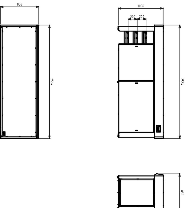
**ELEC :** Puissance Frigorifique : 2222 W - 1 3/8 CV    Reservation Elec : Bornier interne    Raccordement Elec : 230V Mono
