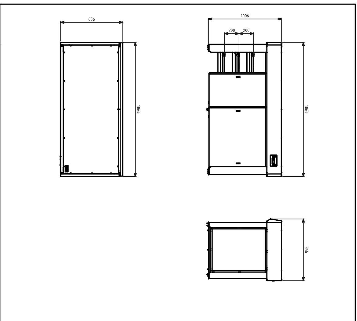
**ELEC :** Puissance Frigorifique : 1549 W - 1 CV    Réservation Elec : Bornier interne    Raccordement Elec : 230V Mono
