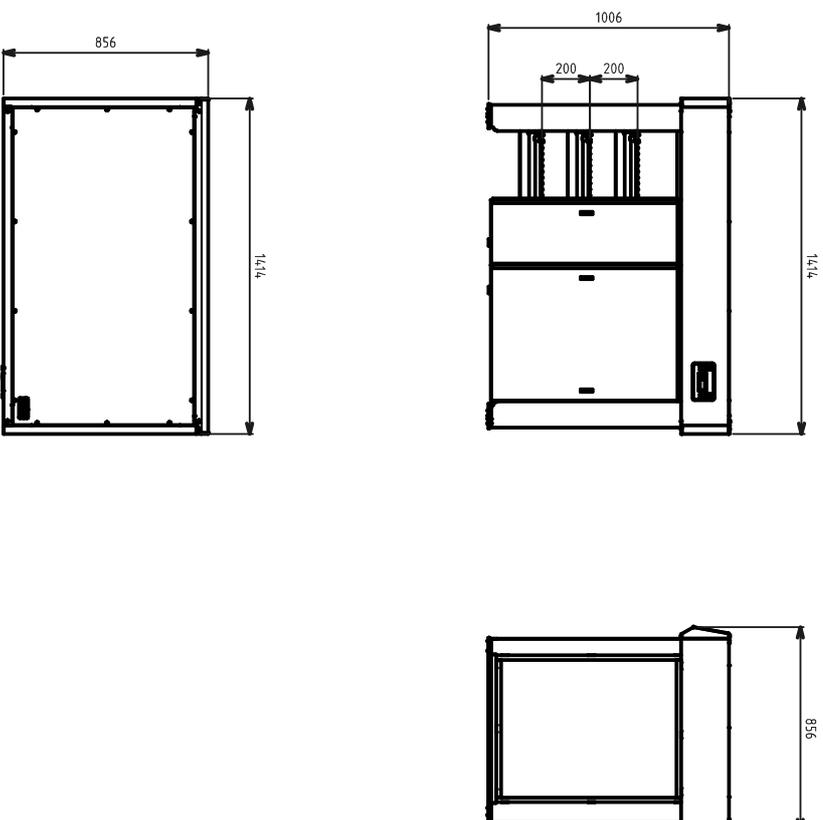
**ELEC :** Puissance Frigorifique : 1549 W - 1 CV    Réservation Elec : Bornier interne    Raccordement Elec : 230V Mono
