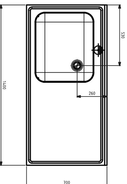
**EAU/AIR :** Raccord eau : 12/17 si option arrivée d'eau
