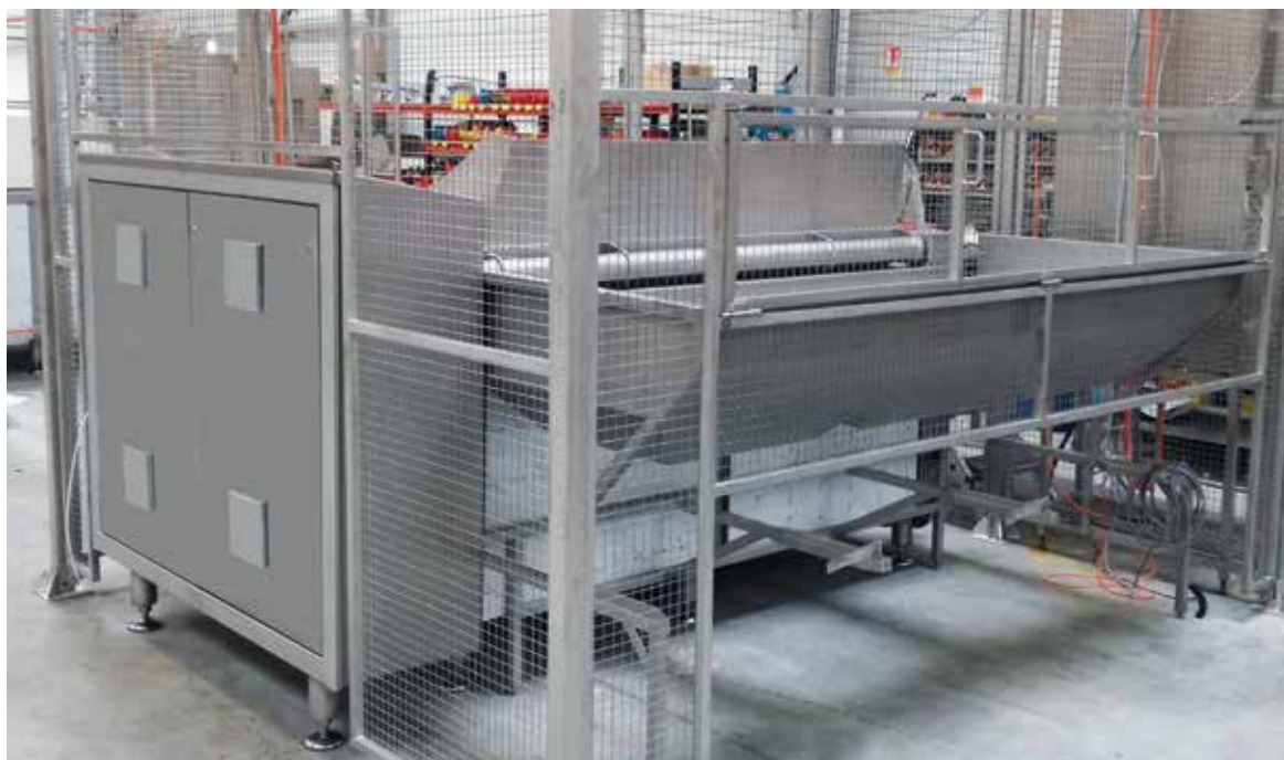
Cuiseur type 1500 Basculement panier par moto-réducteur Zone sécurisée
